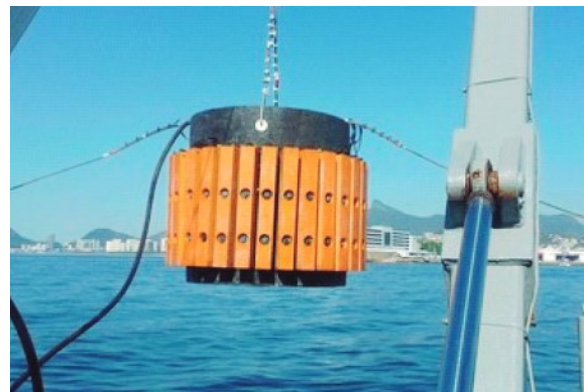
Figura 1: CHA com 32 staves e 96 hidrofones, utilizado pelo IPqM.
