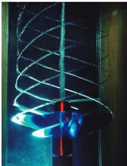
Figura 3: Cavitação do vórtice do cubo e das pontas das pás do propulsor.
