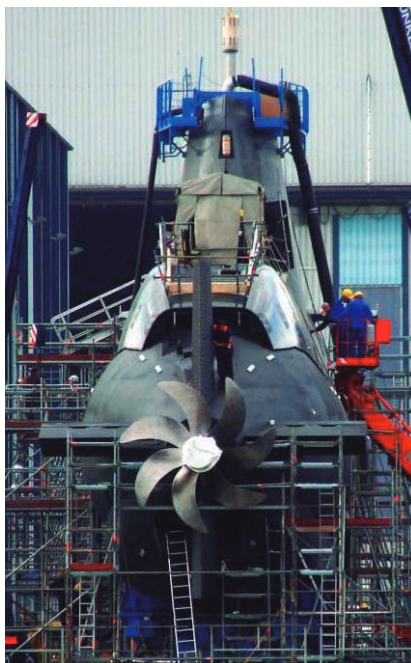
Figura 5: Propulsor de 7 pás.
