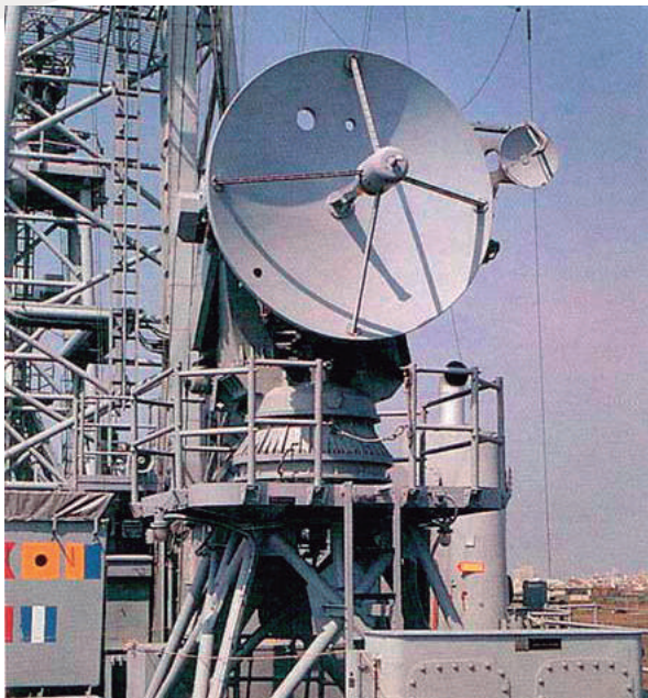
Figura 3 – Antena-radar revestida com RAM.
