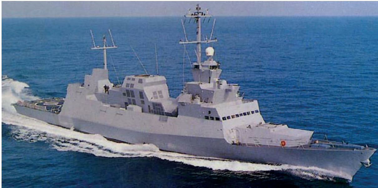
Figura 1: Corveta Israelense stealth da classe Eilat com superestrutura recoberta com RA.
