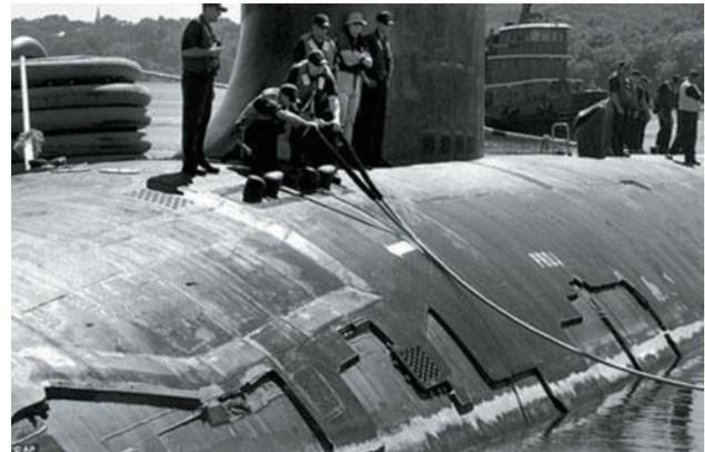
Figura 2: Revestimento do submarino se desprendendo.
