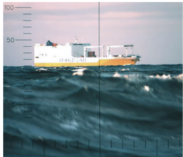
Figura 6: O periscópio, assim como a luneta, possui retículos para determinar as dimensões e a distância do alvo.
