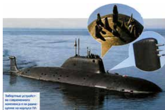
Figura 7: Localização do SOKS em um submarino de ataque russo e fotos em detalhe. (HAMBLING, 2016)
