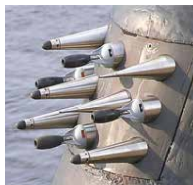
Figura 7: Localização do SOKS em um submarino de ataque russo e fotos em detalhe. (HAMBLING, 2016)
