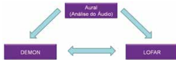
Figura 11 - Relação entre os diferentes tipos de análise dos ruídos de cavitação e maquinaria para a Classificação de Contatos
