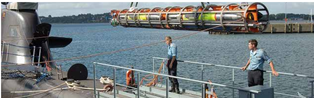
Configuração do casulo de lançamento do sistema IDAS adaptado ao tubo de torpedo do submarino U-33, da classe 212-A.
