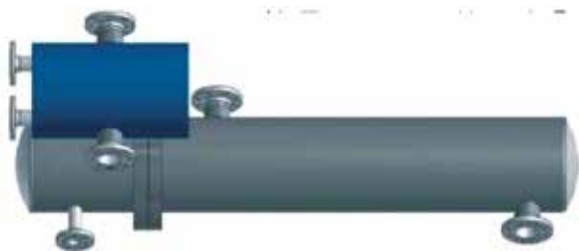
Figura 4 – Comparação de tamanho entre trocadores para mesma carga térmica tipo casco e tubo (cinza) e tipo casco e placas (azul)
