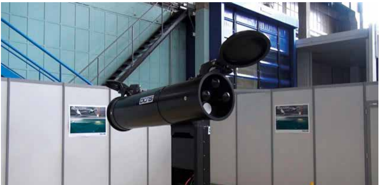
Lançador do míssil MISTRAL 2 a partir de submarinos. Neste sistema, o lançador fica alojado na vela.
