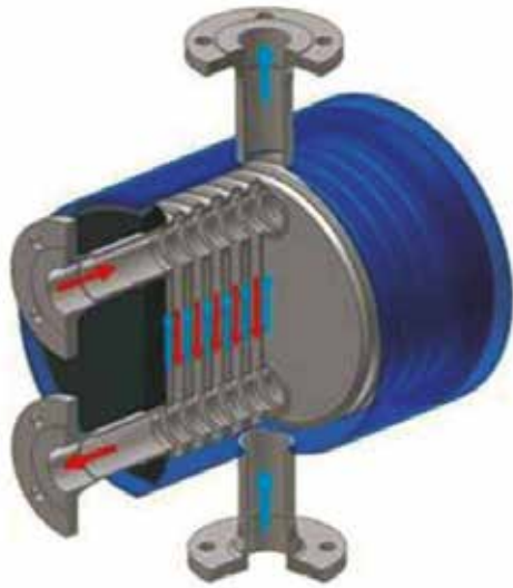
Figura 2 – Trocador de calor casco e placas
