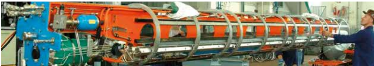
Configuração do casulo de lançamento do sistema IDAS adaptado ao tubo de torpedo do submarino U-33, da classe 212-A.
