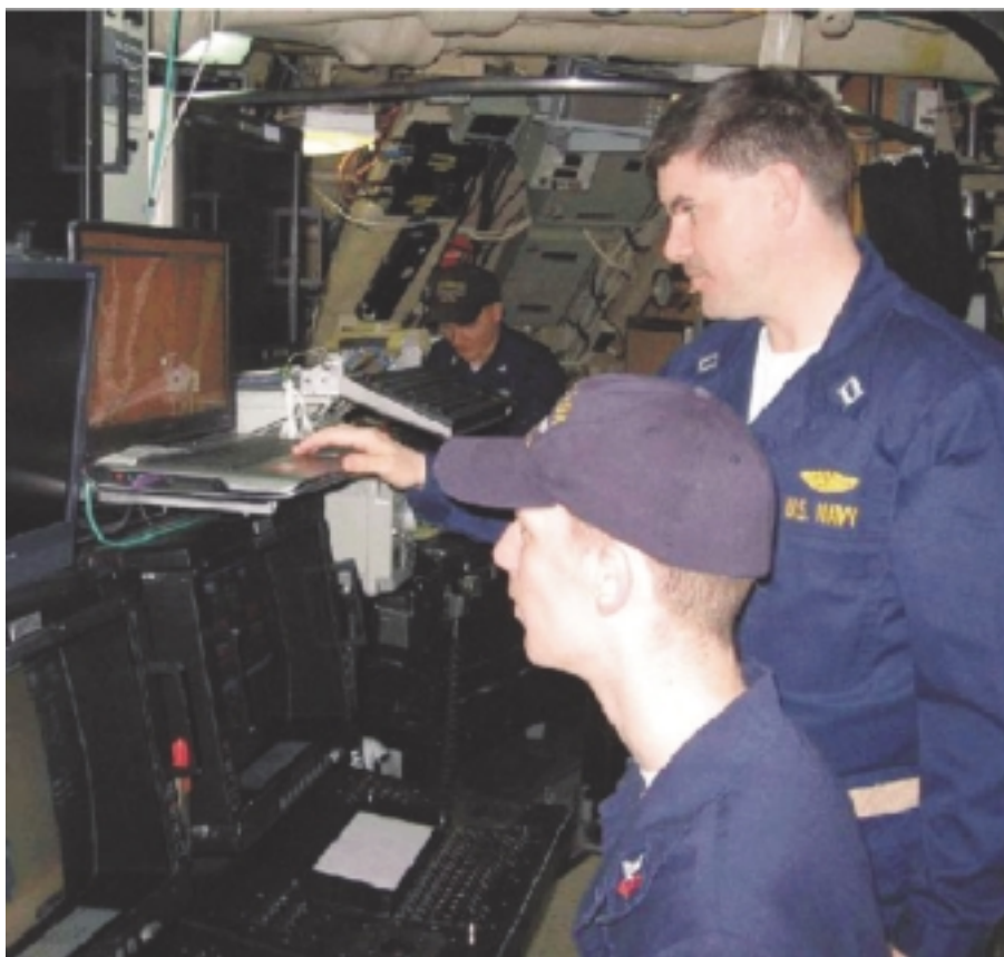
Operação do AIS a bordo do USS NEVADA (SSBN-733). O sistema é integrado a um radar comercial com capacidade ARPA (Automatic Radar Plotting Aids). O radar SCANTER-MIL 24X do S. TIKUNA, possui esta capacidade.
