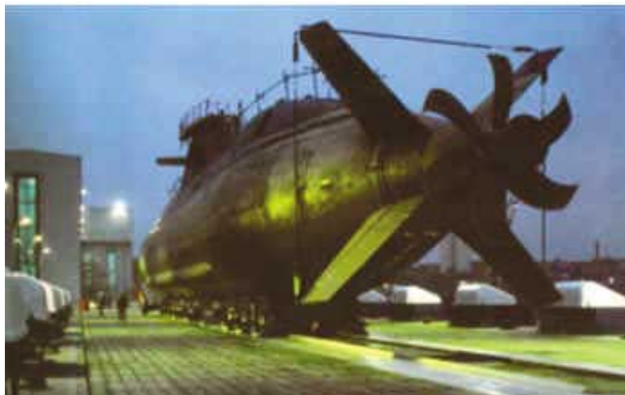
Figura 12 – Submarino alemão Tipo 212A – LLHH-AR em forma de X
