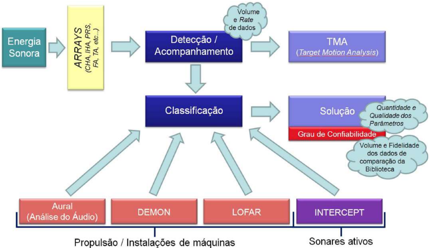
Figura 10 - Utilização da energia sonora por um sistema sonar.
