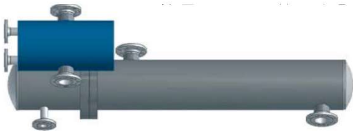
Figura 4 – Comparação de tamanho entre trocadores para mesma carga térmica tipo casco e tubo (cinza) e tipo casco e placas (azul)
