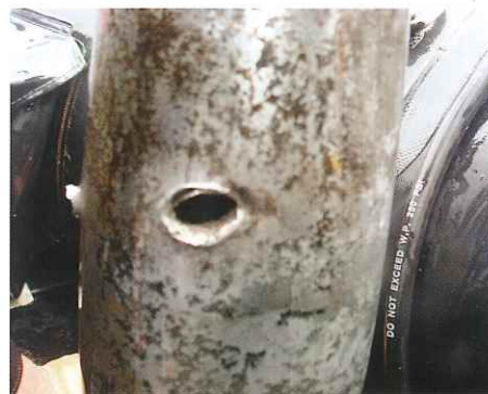
Ataque subaquático em munição de 105mm
