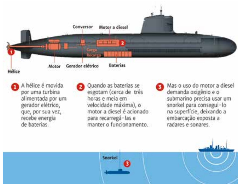
Figura 1: Esquema de um submarino com propulsão diesel-elétrica Fonte: Lopes (2018).
