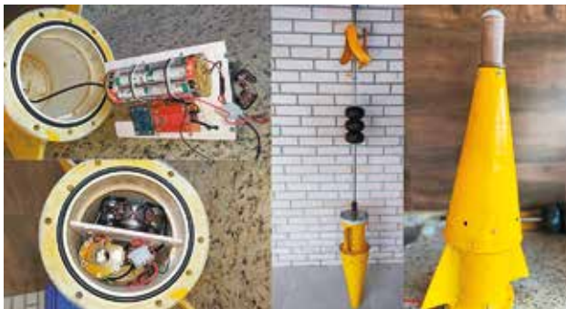
Figura 2: Protótipo do Perfilador Acústico de Queda Livre.
