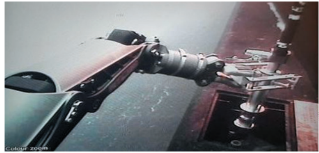
Figura 4: ROV (Conectando mangote de ar de alta pressão e transferindo POD).
