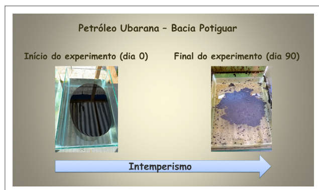
Figura 1. Unidade experimental utilizada para o intemperismo dos diferentes óleos (na imagem, petróleo bruto da Bacia Potiguar).
