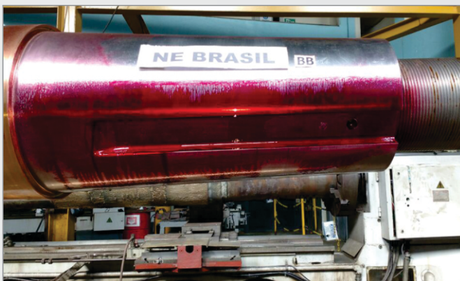
Foto 13 – Inspeção de Líquido Penetrante (LP) no rasgo de chaveira na seção de eixo Propulsor.
