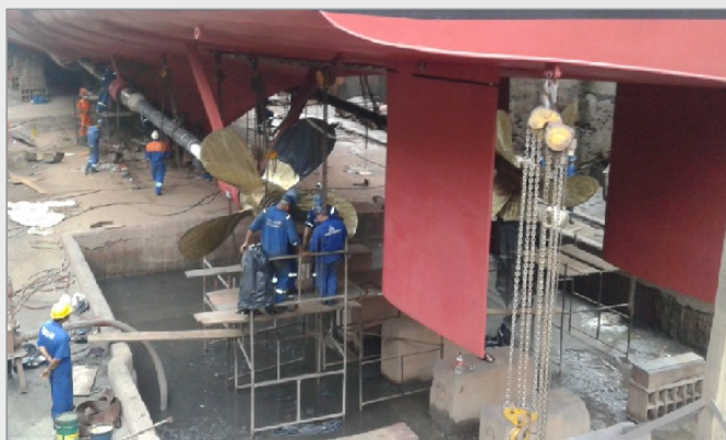
Foto 26 – Montagem das seções de eixo Expostos e Propulsores das linhas de eixo de BB e BE.
