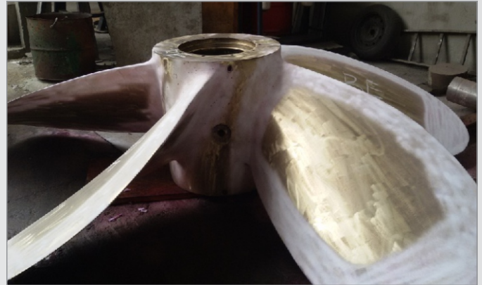
Foto 12 – Inspeção de Líquido Penetrante (LP) nas Pás dos Hélices.
