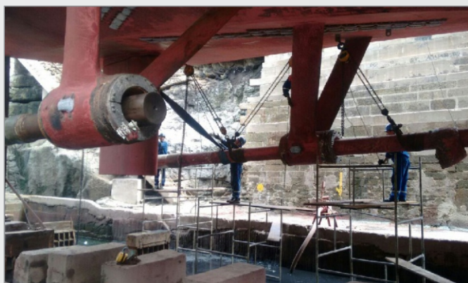
Foto 5 – Desmontagem das seções de eixo Expostas e Propulsoras das linhas de eixo de BB e BE.
