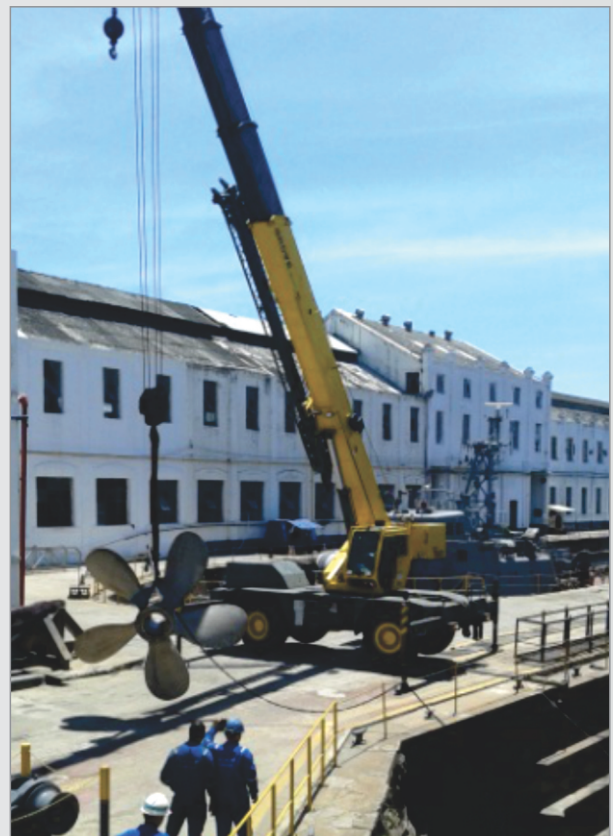
Foto 2 – Retirada dos Hélices do dique e transporte para oficina da Nobre Service..
