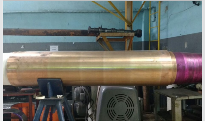
Foto 18 – Usinagem dos moentes das seções de eixo Exposto e Propulsor.
