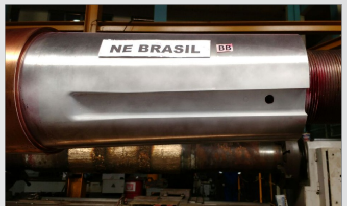
Foto 14 – Inspeção de Líquido Penetrante (LP) no rasgo de chaveira da seção de eixo Propulsor.
