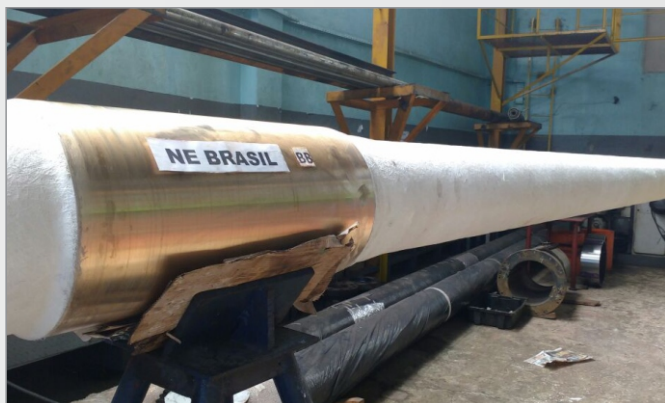
Foto 19 – Fibragem da seção do eixo de BB.
