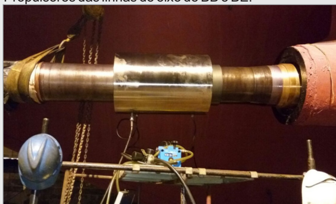
Foto 28 – Acoplamento da luva SKF.
