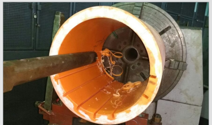
Foto 16 – Usinagem dos moentes das seções de eixo Exposto e Propulsor.
