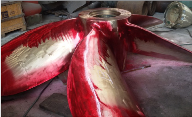
Foto 11 – Inspeção de Líquido Penetrante (LP) nas Pás dos Hélices.
