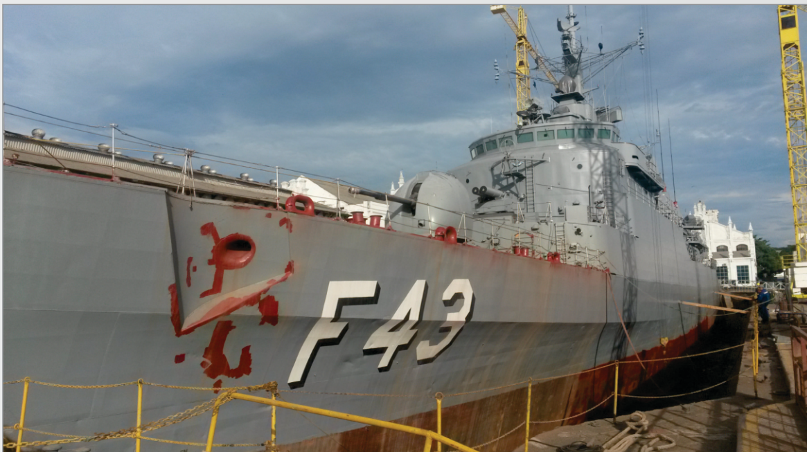
Foto 1 – F Liberal docada no Alte. Branco, destacando as extensas áreas vélicas do costado e superestrutura, não protegidas pelas paredes do dique e expostas à ação do vento.
