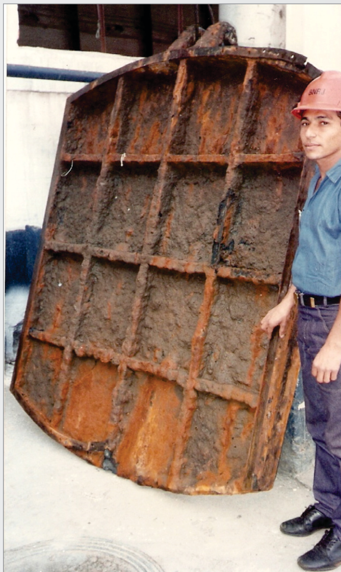
Foto 3 – Antiga comporta (1,7 t) degradada retirada para servir de modelo para a fabricação de outra nova, em ferro fundido nodular.
