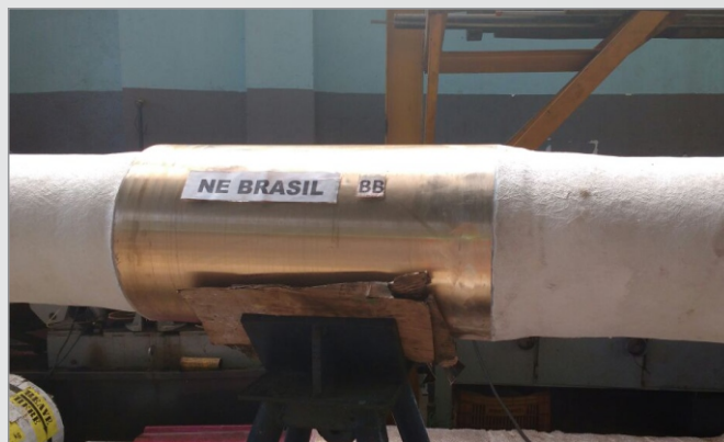
Foto 20 – Fibragem da seção do eixo de BB.
