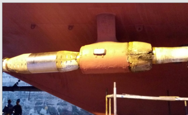
Foto 29 – Montagem da carenagem da luva SKF.
