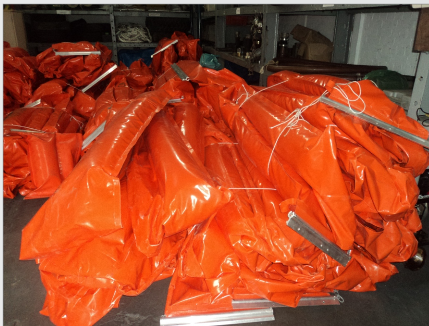
Figura 10 - Barreiras de Contenção Sea Fence, no Paio da Divisão de Proteção Ambiental da BNRJ.
