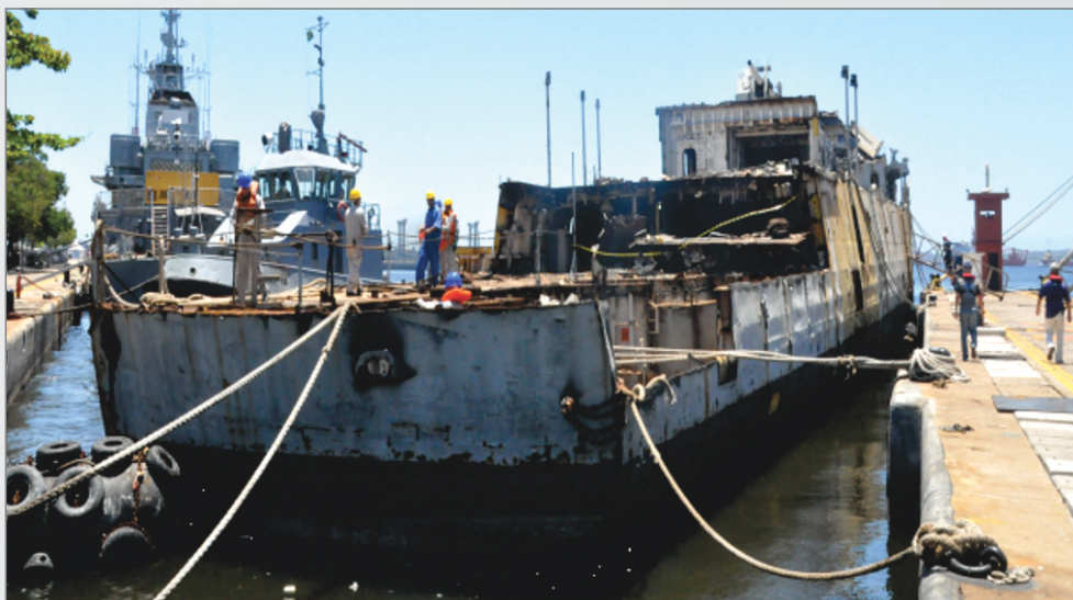
Foto 1 – Situação do casco atracado no Píer 3 interno, já parcialmente desmanchado.
