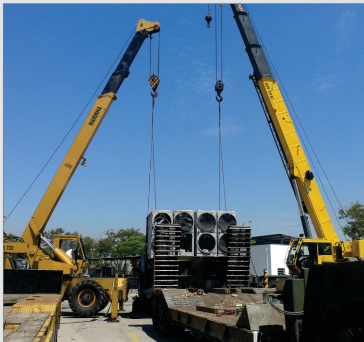
Foto 8 – Operação conjunta de dois guindastes sobre rodas da BNRJ para retirar o lançador de mísseis (20t) ASROC de cima do CavMec do CFN.
