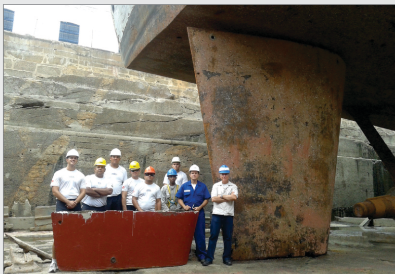
Foto 6 – Detalhe da parte do leme que foi seccionada, enquanto o casco ainda se encontrava flutuando e, também, da atuação do leme como uma “coluna de fortuna” apoiando a popa.
