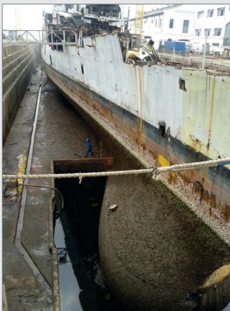
Foto 5 – Domo alojado no fosso, que é destinado aos hélices das Fragatas Classe Niterói.
