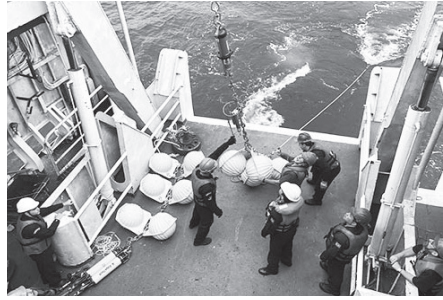
Fundeio de correntômetro e micro CAT no Canal Vema
