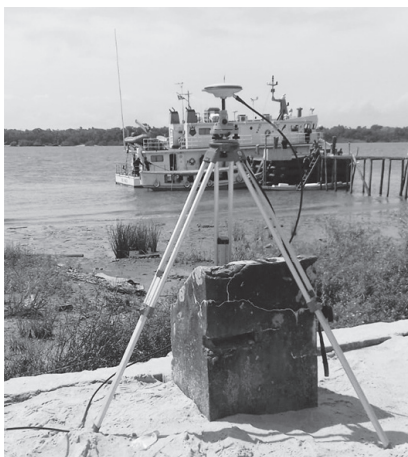
Rastreio Estático de Referência de Nível na estação maregráfica de Ponta Negra – PA. O AvHoFlu Rio Xingu no trapiche ao fundo
