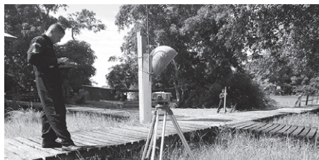
Militar realiza nivelamento geométrico na Estação Maregráfica de Ponta do Céu
