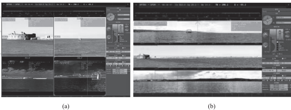
Figura 3: (a) Interface homem/máquina do mastro optrônico de busca, com as visadas normais das câmeras infravermelhas e HDTV e (b) Interface homem/máquina do SOM, com as visadas panorâmicas das câmeras infravermelhas e HDTV. Fonte: Site da empresa Sagem-Safran ( http://www.safran-electronics-defense.com/fr/file/download/d1755_series_30_som.pdf ), acesso em 29/10/2016
