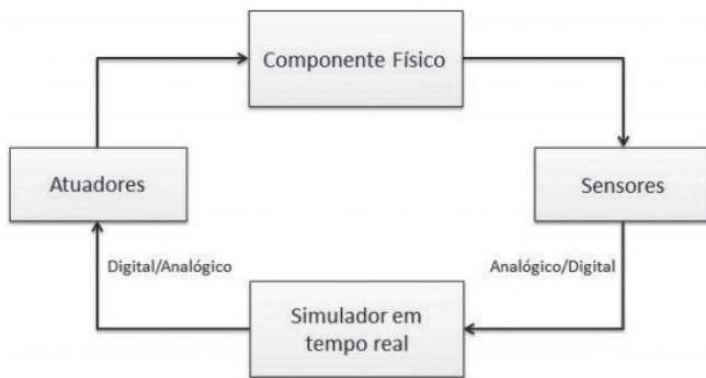
Figura 6 – Diagrama de blocos simplificado de uma arquitetura HIL Fonte: LOPES, 2017. Adaptada pelo autor
