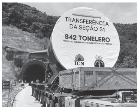
Deslocamento da seção S1 do Submarino Tonelero próximo ao túnel que liga a área Sul
