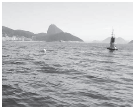
Boia Spotter V-2 coleta dados oceanográficos
