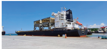
Navio Mercante Mandarin Arrow suspendendo com auxílio do Sistema ReDraft para determinação de FDAQ
