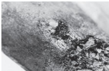
Figura 10 – Corrosão gráfitica (Ponte, 2003)
