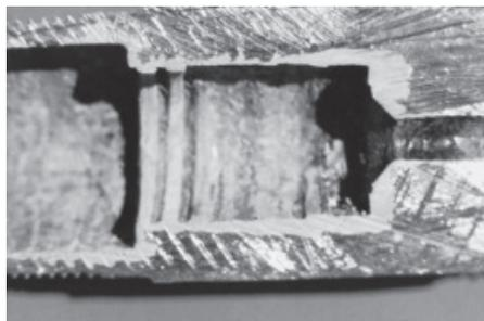
Figura 9 – Corrosão por dezinsificação (Arruda, 2009)
