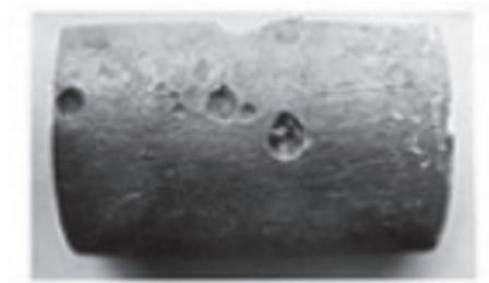
Figura 3 – Corrosão Alveolar (Ponte, 2003)
