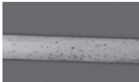
Figura 4 – Corrosão por Pite (Arruda, 2009)
