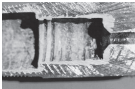
Figura 9 – Corrosão por dezinsificação (Arruda, 2009)
