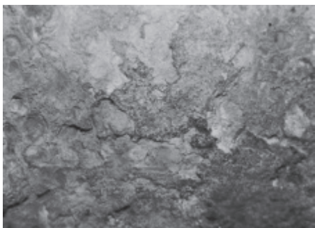
Figura 1 – Corrosão Uniforme (Ponte, 2003)
