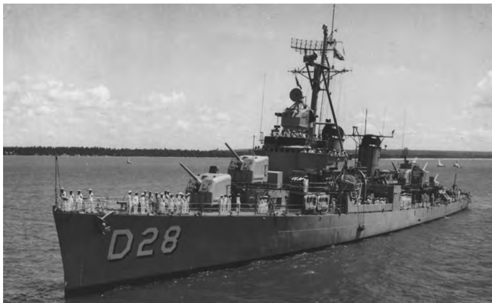
CT Paraíba – comprimento total: 115m; calado: 4,7m; deslocamento a plena carga: 3.000 toneladas; e velocidade máxima: acima de 30 nós
