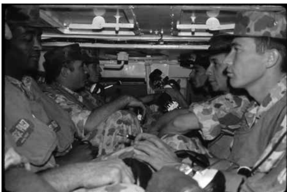
Fig. 12 – Interior do Urutu transportando tropa equipada. Observem-se as escotilhas do teto, muito estreitas
