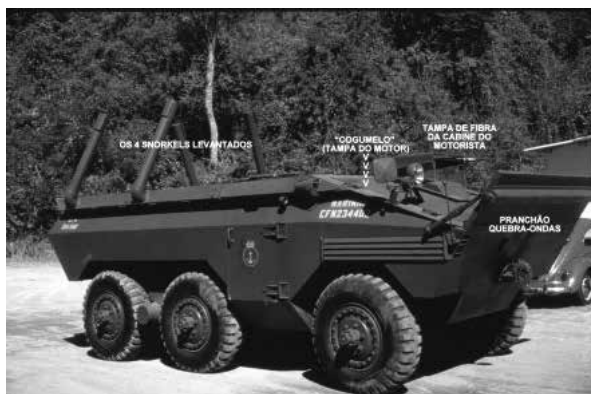
Fig. 7 – Alguns dos dispositivos acionados para entrada na água
