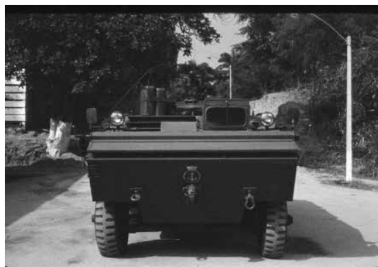
Fig. 10 – Urutu visto de frente. Observe-se a cobertura e o para-brisas rebatível da cabine do motorista
