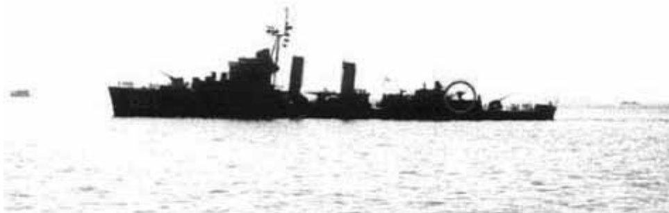
Contratorpedeiro D-26 Mariz e Barros . No detalhe, o lançador quádruplo do MAS Sea Cat. (Fonte: revista Segurança e Defesa )
