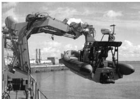
Grua de costado
