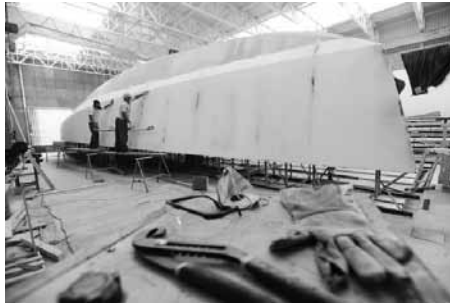
Veleiro com casco em alumínio e interior em fibra de vidro – Foto: Cristiano Estrela/Agência RBS
