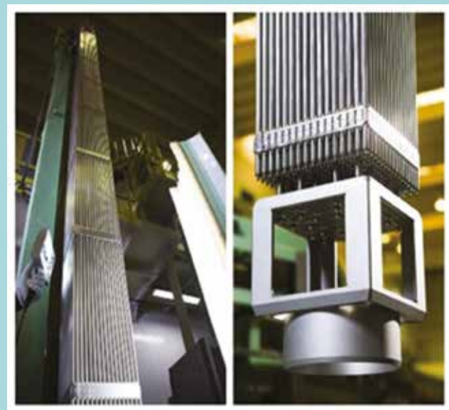
Figura 5 – Detalhe do elemento combustível: conjunto de 235 varetas combustíveis – fabricadas em zircaloy – rigidamente posicionadas em uma estrutura metálica, formada por grades espaçadoras; 21 tubos-guias e dois bocais, um inferior e outro superior Fonte: INB.
