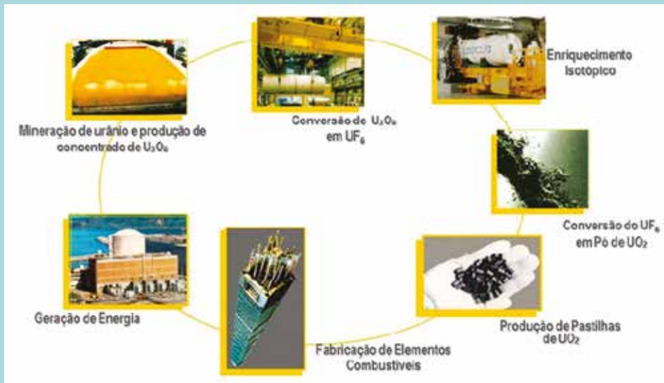
Figura 4 – A produção do combustível nuclear consiste de um conjunto de etapas industriais que se inicia com a mineração e termina com a montagem dos elementos combustíveis Fonte: INB.
