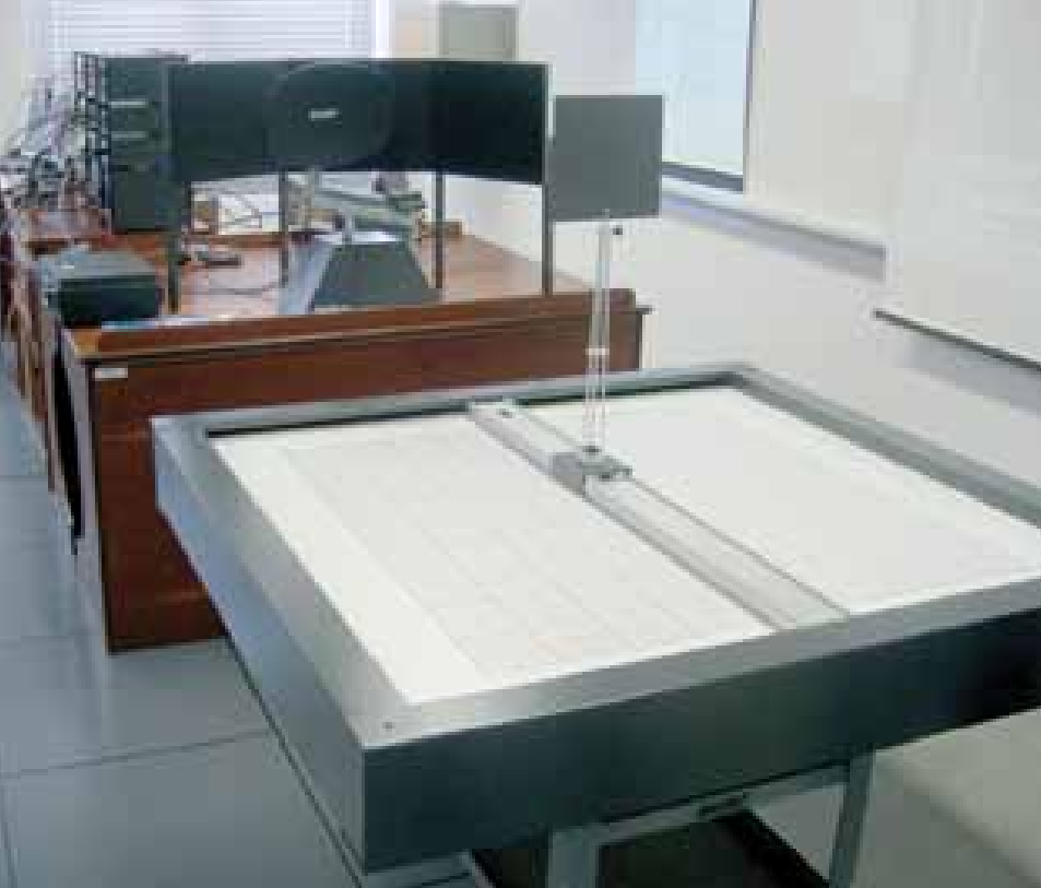
Mesa de alvos e o radar de laboratório ao fundo.
