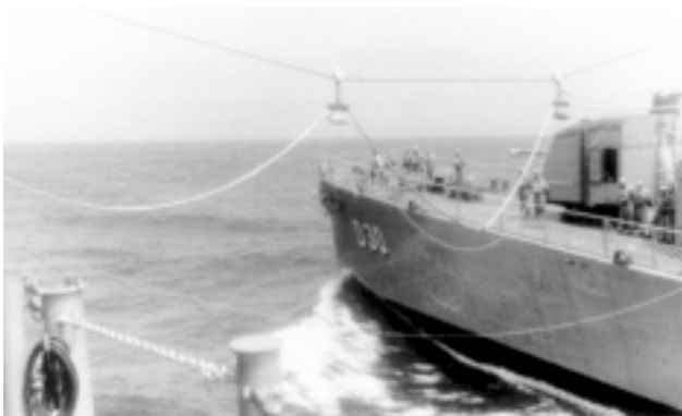
D-30 realizando faina de transferência de carga leve e recebimento de aguada com o Cruzador Barroso (C11), em 1961
