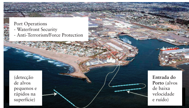
Figura 12. Sistema de vigilância antiespionagem e antiterrorismo, empregando sensores (submersos) acústicos a fibra ótica em Port Hueneme, Califórnia – EUA [11].
