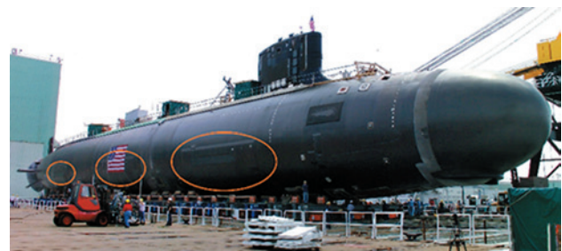
Figura 11 (b). Localização dos 6 hidrofones (3 de cada lado do casco) [11].
