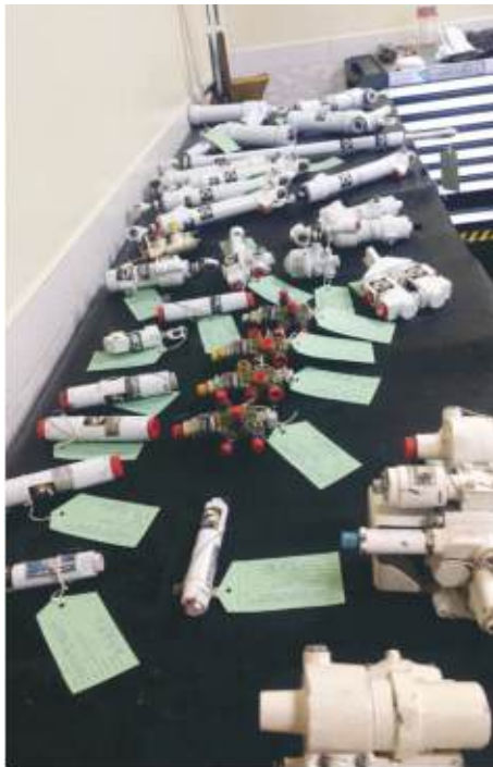
Diversos componentes hidráulicos da aeronave AF-1
