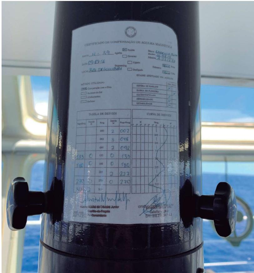
Figura 3 – Certificado de compensação da agulha magnética padrão
