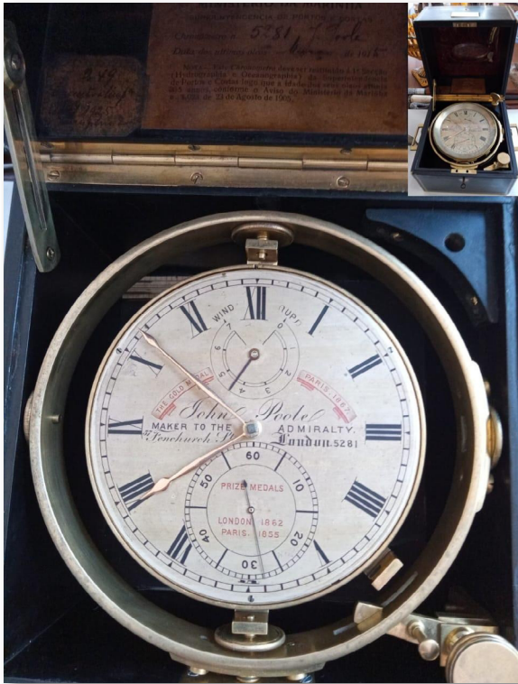
Figura 14- Cronômetro marítimo John Pool mecânico de corda, utilizado na Marinha do Brasil no século XX. Fonte: Elaborado pelo autor com base no acervo fotográfico pessoal do Diretor de Hidrografia e Navegação.
