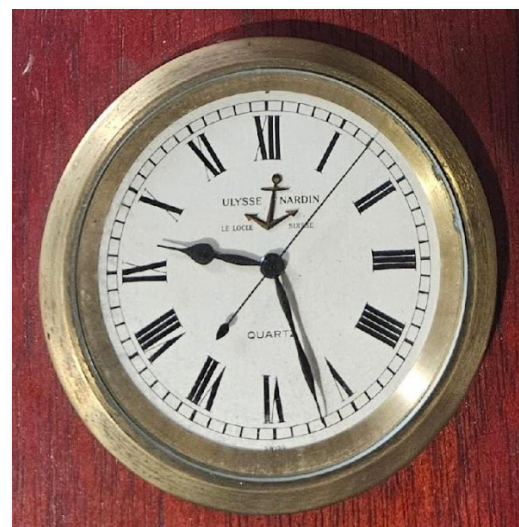
Figura 13- Cronômetro Marítimo Ulysse Nardin de quartzo, utilizado atualmente no Navio Hidroceanográfico Faroleiro “Almirante Graça Aranha”. Fonte: Acervo fotográfico pessoal do autor.
