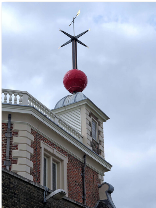
Figura 11- Time Ball de Greenwich, dispositivo visual para acerto de relógios. Fonte: OAKLEY, Malcolm. Greenwich – A Place of Time and Space. Easy Malc, 2021. Disponível em: https://www.easymalc.co.uk/greenwich-a-place-of-time-and-space/ . Acesso em: 05 ago. 2025.
