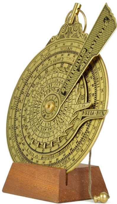
Figura 3- Nocturlábio: instrumento utilizado, principalmente entre os séculos XIV e XVI, para medir o tempo, no período da noite, e estimar a longitude a partir de astros cujos movimentos no céu eram conhecidos. Fonte: Disponível em: https://www.lojadomuseudemarinha.pt/pt/nocturlabio-girolamo-della-volpaia.html . Acesso em: 5 ago. 2025.
