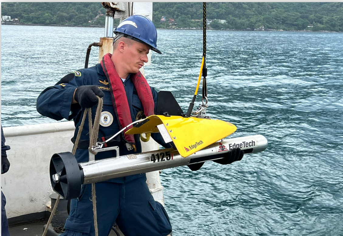
Operação do sonar de varredura lateral Edgetech 4125i a bordo do AvPqHoAspMoura.
