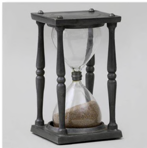
Figura 8- Ampulheta Marinha de 30 Minutos: Instrumento de Navegação nos Séculos XV–XIX. Fonte: WIKIPEDIA. Marine sandglass. Disponível em: https://en.wikipedia.org/wiki/Marine_sandglass . Acesso em: 05 ago. 2025.
