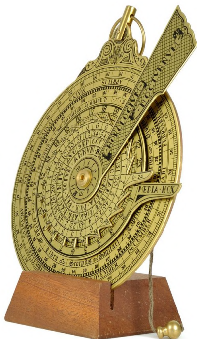
Figura 3- Nocturlábio: instrumento utilizado, principalmente entre os séculos XIV e XVI, para medir o tempo, no período da noite, e estimar a longitude a partir de astros cujos movimentos no céu eram conhecidos. Fonte: Disponível em: https://www.lojademuseudemarinha.pt/pt/nocturlabio-girolamo-della-volpaia.html . Acesso em: 5 ago. 2025.
