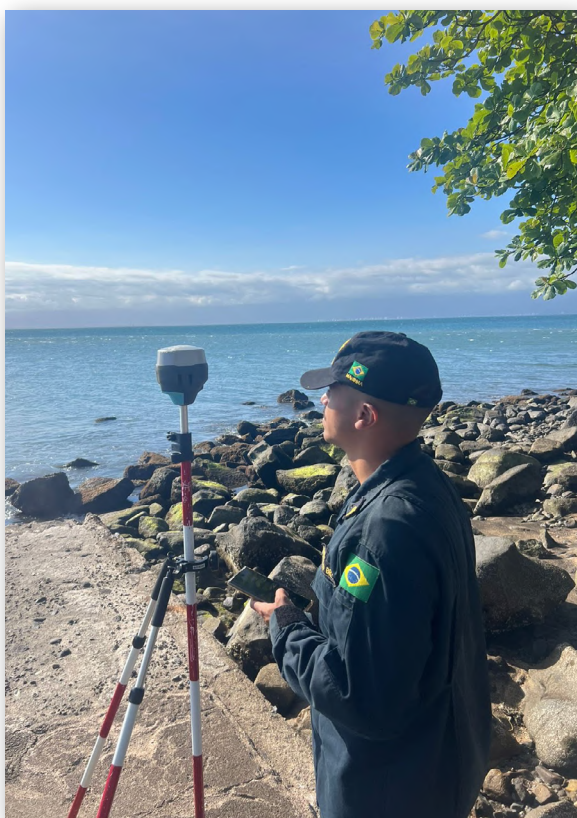
Rastreio estático com o rastreador Emlid Reach RS2.
