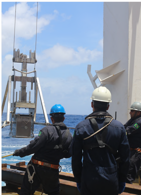
Lançamento de Box-Corer durante a COGES I/2024 – MEQ
