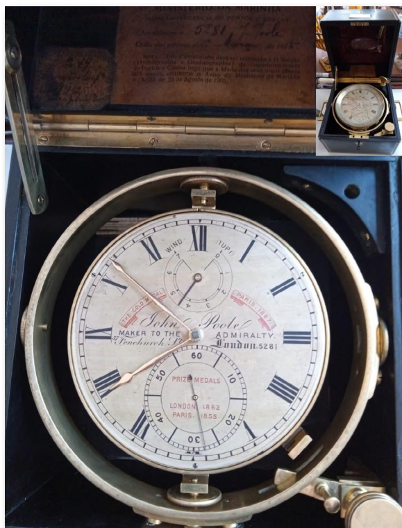
Figura 14- Cronômetro marítimo John Pool mecânico de corda, utilizado na Marinha do Brasil no século XX. Fonte: Elaborado pelo autor com base no acervo fotográfico pessoal do Diretor de Hidrografia e Navegação.
