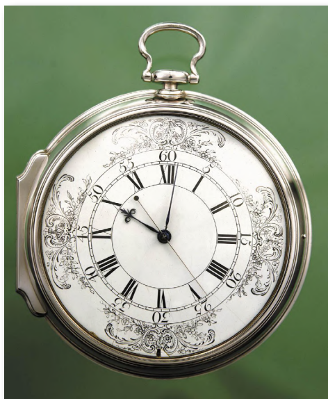
Figura 10- Cronômetro Marítimo H4 de John Harrison, vencedor do Concurso da Longitude. Fonte: SJX WATCHES. In-Depth: The Microscopic Magic of H4, Harrison's First Sea Watch. Disponível em: https://watchesbysjx.com/2019/09/john-harrison-marine-chronometer-h4-diamond-pallets.html .
