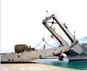
**Figura 3:** O Tank Landing Ship (LST) e USS Frederick (LST 1184) da Marinha dos EUA, com uma rampa em arco para embarcar os Marines e equipamentos, em 29 de março de 1996. Os LSTs dos EUA foram usados para transportar tanques de terra, veículos anfíbios e outros materiais circulantes em operações de assalto anfíbio.
