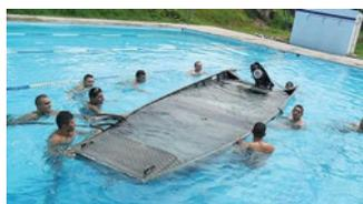
Figura 1: Teste de comprovação da flutuabilidade das ETT adaptadas com garrafas Pet
