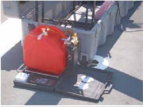
Figura 2 - Sistema de abastecimento com respectiva balança
