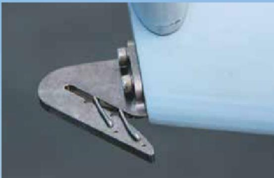
Figura 6 - Detalhe do sistema de gancho na ponta da asa
