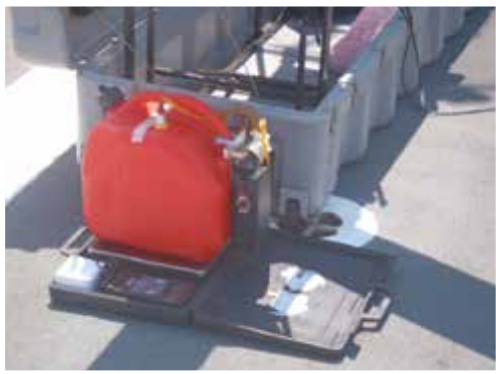
Figura 2 - Sistema de abastecimento com respectiva balança
