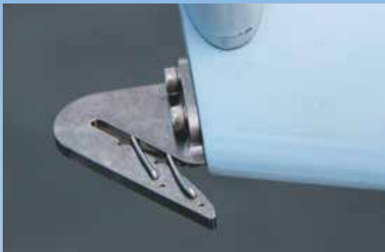
Figura 6 - Detalhe do sistema de gancho na ponta da asa
