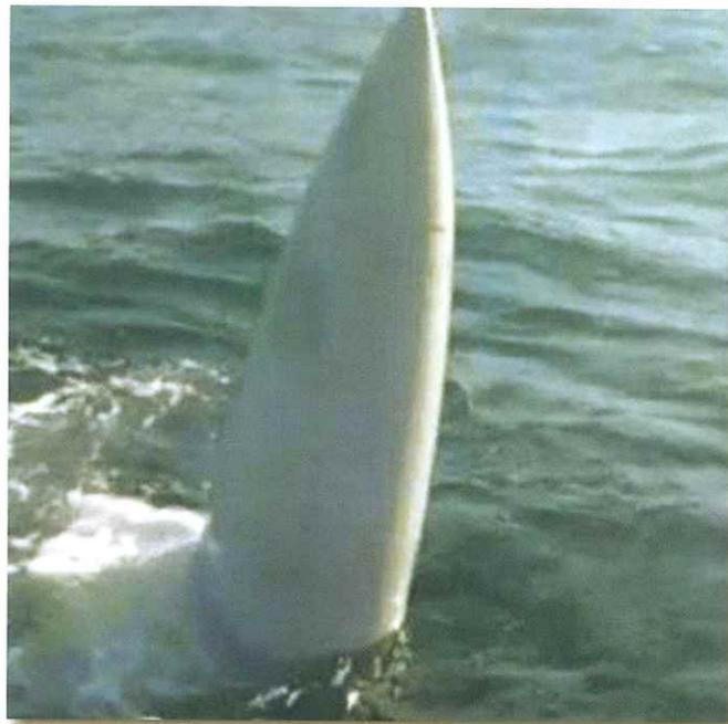
Figura 1: Tanque subalar desprendido da aeronave N-1001
