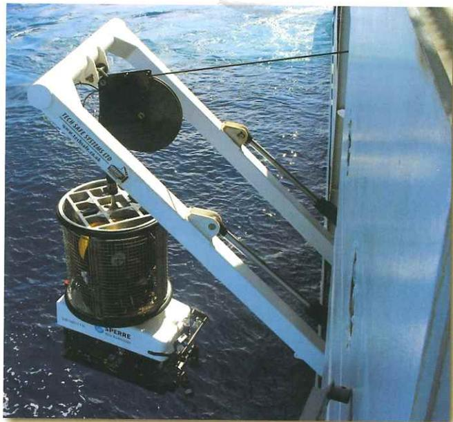
Figura 4: Veículo Submarino Operado Remotamente do Navio Hidroceanográfico Vital de Oliveira
