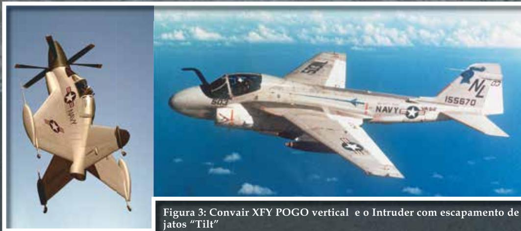
Figura 3: Convair XFY POGO vertical e o Intruder com escapamento de jatos “Tilt”
