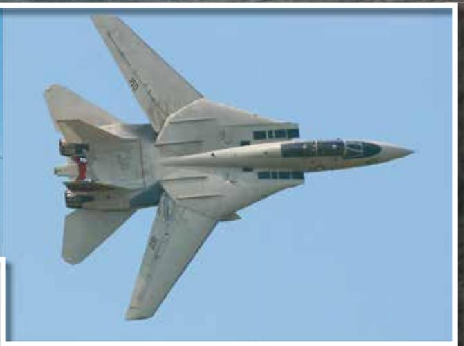
Figura 4: F-8 Crusader abaixando as asas para pouso e F-14 com geometria variável
