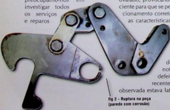
fig 2 - Ruptura na peça
