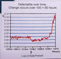
Figura 2. Defeito Identificado no Eixo do Resfriador de Óleo da Transmissão.
