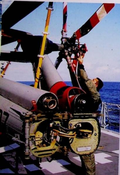
O Lynx já pronto para ser hangarado: "penteado", cone de cauda rebatido e com os cabos do guincho hidráulico presos aos trens de pouso.
