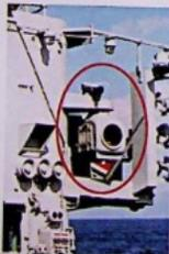
velocidade em relação ao solo, altitude (rádio-altímetro) e a cor do GPI – Glide Path Indicator, conjunto ótico calibrado para mostrar ao piloto as cores âmbar para "acima da rampa ideal", verde para "na rampa" e vermelho para "abaixo da rampa ideal".
