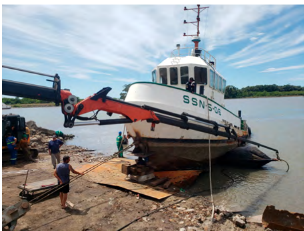
Docagem pioneira na ENRG pelo método de airbags do Aviso Balizador “Rigel”
